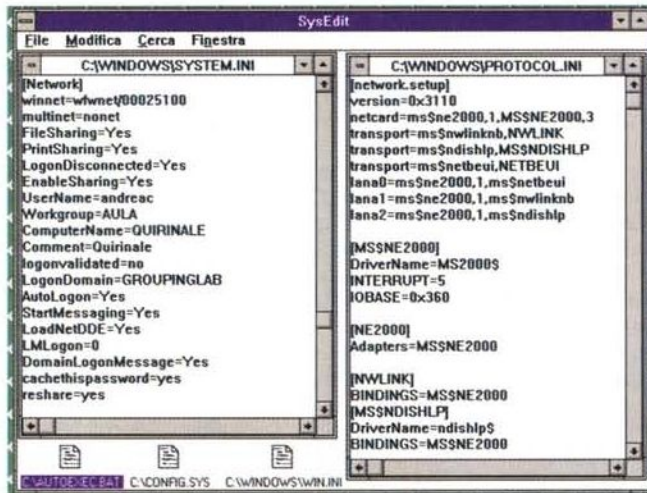
Figura 10 - Windows per Workgroup - I file SYSTEM.SYS e PROTOCOL.INI. In questa figura si vede uno stralcio dei due file di inizializzazione di WfW che maggiormente riguardano la nuova condizione dell'ambiente. Nel SYSTEM.INI vi sono diverse sezioni in più, rispetto al System.ini di un Windows semplice, che hanno a che vedere con la rete. Il PROTOCOL.INI invece è un file completamente nuovo. Nella directory System di Windows si trova il programma SYSEDIT.EXE, che permette di aprire contemporaneamente i file di
